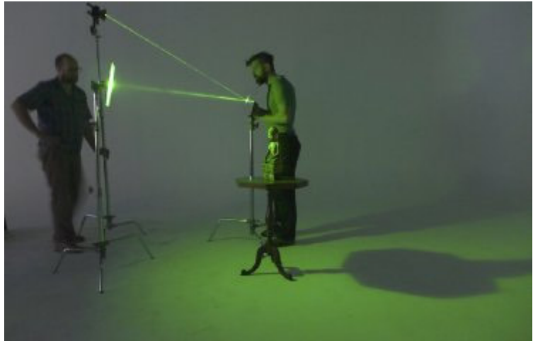
So haben wir das Demo-Set aufgebaut: Laser auf den ersten Paniflektor schwarz und von dort aus der Reihe nach auf einen Paniflektor der übrigen sechs verschiedenen Typen. Danach folgt, um die zahlreichen Varianten zu veranschaulichen, die Wirkung der Reflektorentypen und Größen in diversen Kombinationen.
