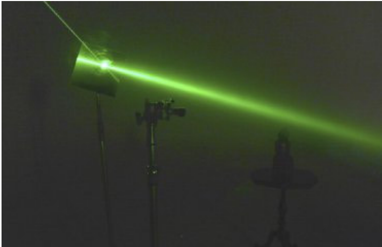
Von links oben zielt der Laserstrahl auf einen schwarzen Paniflektor, der vor allem zur Lichtumlenkung verwendet wird, mit einer minimalen Aufweitung, um einen reinen Spiegeleffekt zu vermeiden und mit sehr geringem Verlust, beinahe Totalreflektion
