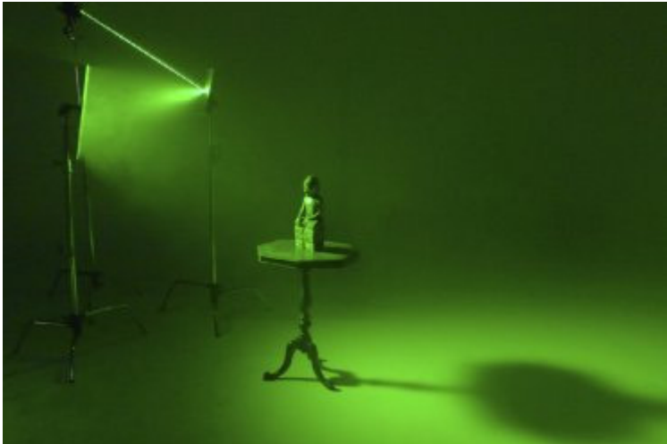
blau 30 x 30 auf blau 50 x 50 cm, ergibt eine Aufweitung der Diffusion durch den größeren Reflektor und ein weiches Schattenbild
