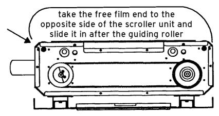
Den Film spannen, indem Sie den Zahnriemen in die gekennzeichnete Richtung ziehen. Ist er gespannt, dann 10 bis 12 Umdrehungen der Zahnscheiben (abhängig von der Filmlänge) gegen die Federkraft vorspannen. Fixieren Sie die Filmspannung durch Anziehen der beiden Schrauben der Halteklammer. /
