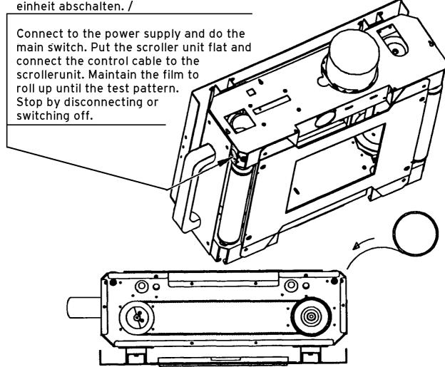
Das freie Filmende an der gegenüberliegenden Seite der Scrollereinheit über die Umlenkrolle führen und einfädeln
