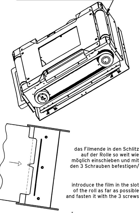
Sollte eine der drei Schrauben beschädigt sein, so ist diese unverzüglich zu ersetzen, um eine schwierige Reperatur zu vermeiden. /
